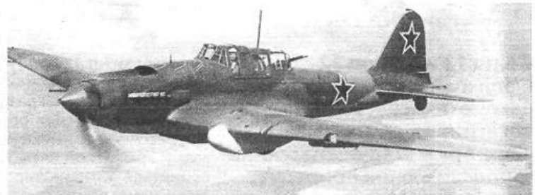
Ил-2 – одномоторный самолет смешанной конструкции. Главная особенность – включение брони в силовую схему планера. Самый массовый боевой самолет в истории авиации, было выпущено более 36 тысяч штук. Ил-2 принимал участие в боях на всех театрах военных действий Великой Отечественной войны, а также в Советско-японской войне.
